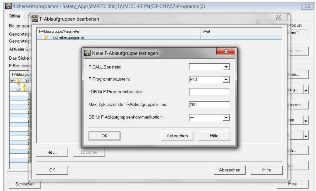
4. ➔ Tragen Sie als "F\_CALL Baustein" den FC2 ein. Dieser FC wird automatisch angelegt, sobald Sie das Dialogfeld *"F-Ablaufgruppen bearbeiten"* mit [OK] verlassen haben. Ein Instanz-DB (I-DB) für den F-Programmbaustein ist nicht erforderlich, da ein FC als F-Programmbaustein verwendet wird. Die max. Zykluszeit der F-Ablaufgruppe soll 200ms betragen. Ein DB- für F-Ablaufgruppenkommunikation ist nicht erforderlich.
