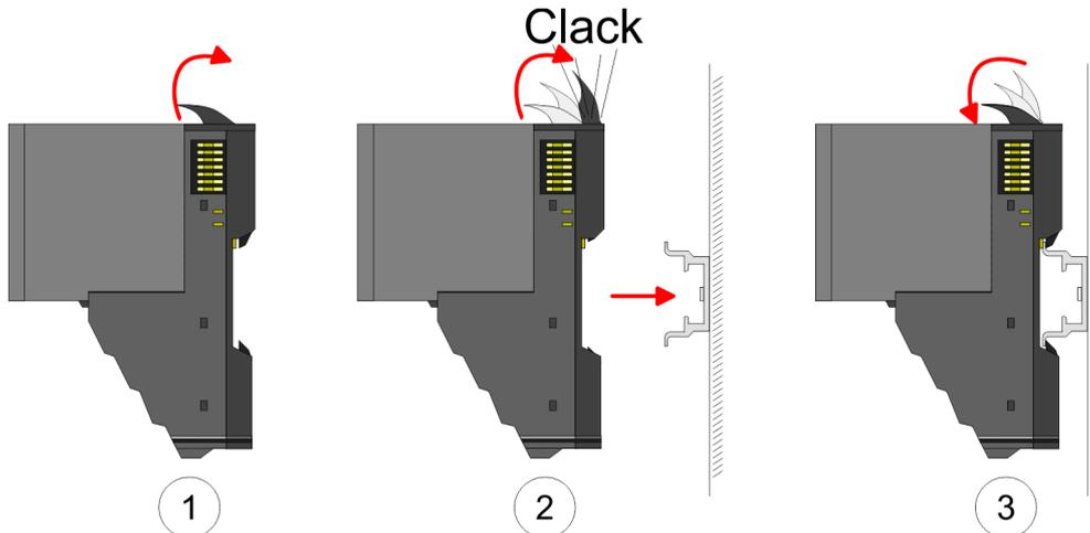
Zum Austausch eines Elektronik-Moduls können Sie das Elektronik-Modul, nach Betätigung der Entriegelung an der Unterseite, nach vorne abziehen. Für die Montage schieben Sie das Elektronik-Modul in die Führungsschiene, bis dieses an der Unterseite hörbar am Terminal-Modul einrastet.
