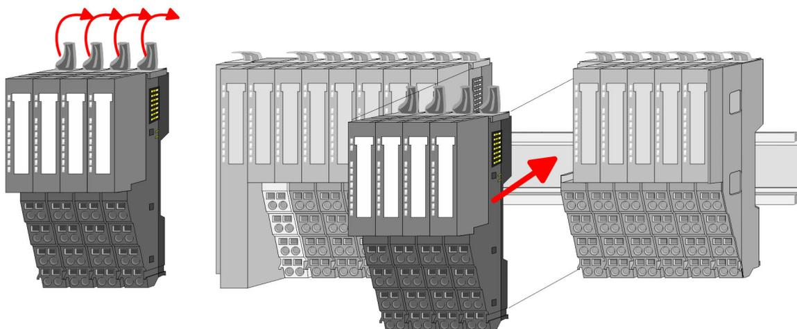
5. → Zur Montage klappen Sie alle Verriegelungshebel der zu montierenden Modulgruppe nach oben.
