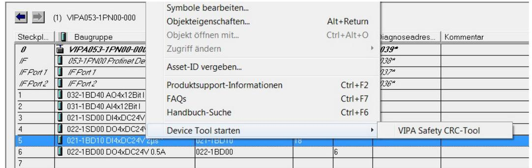
2. Validieren Sie im CRC-Tool entsprechend der Anleitung "Validation des Systems" alle Parameter mit der [Übernahme]-Schaltfläche und berechnen Sie anschließend mit [CRC-Berechnen] die Prüfsumme. Die [CRC-Berechnen]-Schaltfläche ist erst freigegeben, wenn alle Parameter "übernommen" sind. *"Validation des Systems"...Seite 122*
