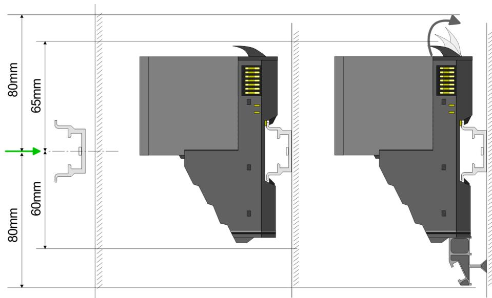
→ Montieren Sie die Tragschiene! Bitte beachten Sie, dass Sie von der Mitte der Tragschiene nach oben einen Montageabstand von mindestens 80mm und nach unten von 60mm bzw. 80mm bei Verwendung von Schirmschienen-Trägern einhalten.
