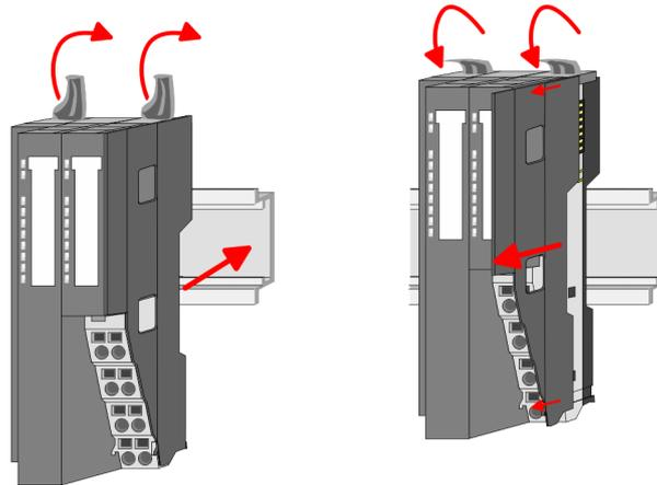
1. ➔ Beginnen Sie auf der linken Seite mit dem Kopf-Modul (z.B. Bus-Koppler). Klappen Sie hierzu beide Verriegelungshebel des Kopf-Moduls nach oben, stecken Sie das Kopf-Modul auf die Tragschiene und klappen Sie die Verriegelungshebel wieder nach unten.
