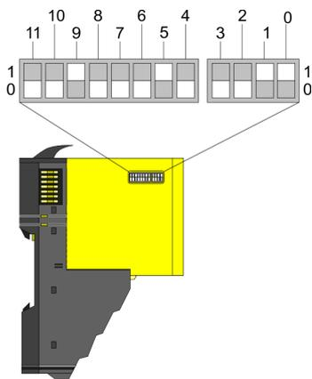
Die F-Adresse ist mit dem F-Adress-Schalter am Safety-Modul einzustellen und zusätzlich im Mastersystem z.B. Hardware-Konfigurator zu projektieren. Die F-Adresse können Sie mit dem seitlich am Safety-Modul befindlichen Adress-Schalter einstellen. Nur wenn die im Hardware-Konfigurator und am Modul eingestellte F-Adresse übereinstimmt, ist ein Betrieb möglich!
