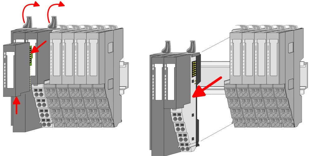
2. Betätigen Sie die Entriegelung an der Unterseite des rechts neben dem Kopf-Modul befindlichen Elektronik-Moduls und ziehen Sie dieses nach vorne ab.
