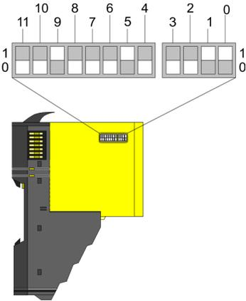
Die F-Adresse bzw. "Sichere Teilnehmeradresse" ist mit dem F-Adress-Schalter am Safety-Modul einzustellen und zusätzlich im Mastersystem z.B. Hardware-Konfigurator zu projektieren. Die F-Adresse können Sie mit dem seitlich am Safety-Modul befindlichen Adress-Schalter einstellen. Nur wenn die im Hardware-Konfigurator und am Modul eingestellte F-Adresse übereinstimmt, ist ein Betrieb möglich!
