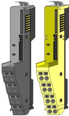
Das *Terminal-Modul* bietet die Aufnahme für das Elektronik-Modul, beinhaltet den Rückwandbus mit Spannungsversorgung für die Elektronik, die Anbindung an die DC 24V Leistungsversorgung und den treppen-förmigen Klemmblock für die Verdrahtung. Zusätzlich besitzt das Terminal-Modul ein Verriegelungssystem zur Fixierung auf einer Tragschiene. Mittels dieser Verriegelung können Sie Ihr System SLIO außerhalb Ihres Schaltschranks aufbauen und später als Gesamtsystem im Schaltschrank montieren.
