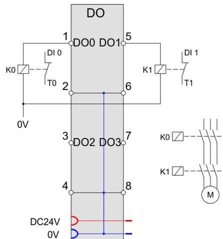
Sie können eine Last (z.B. Relais) zwischen einem Safety-Ausgang DO 0 ... 3 und dem Masseanschluss 0V der Feldversorgungsspannung anschließen. Es ist nicht erforderlich den Masseanschluss auf die entsprechende Klemme des System Safety-Moduls zurückzuführen.
