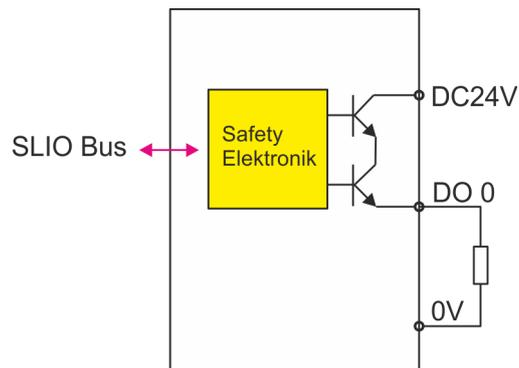
**Anschluss einer Last an einem Safety-Ausgang**
