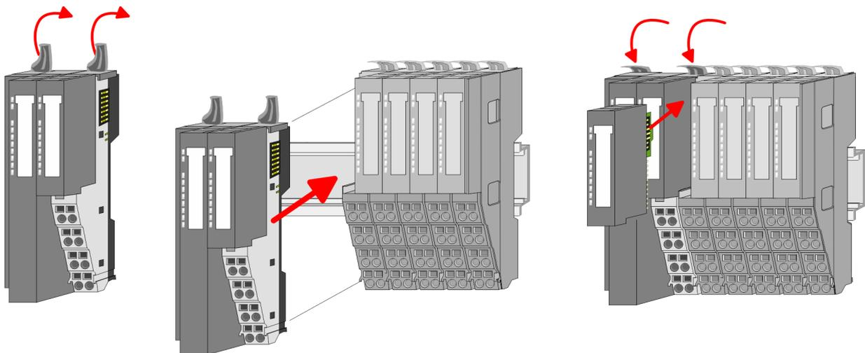
5. Zur Montage klappen Sie alle Verriegelungshebel des zu montierenden Kopf-Moduls nach oben.
