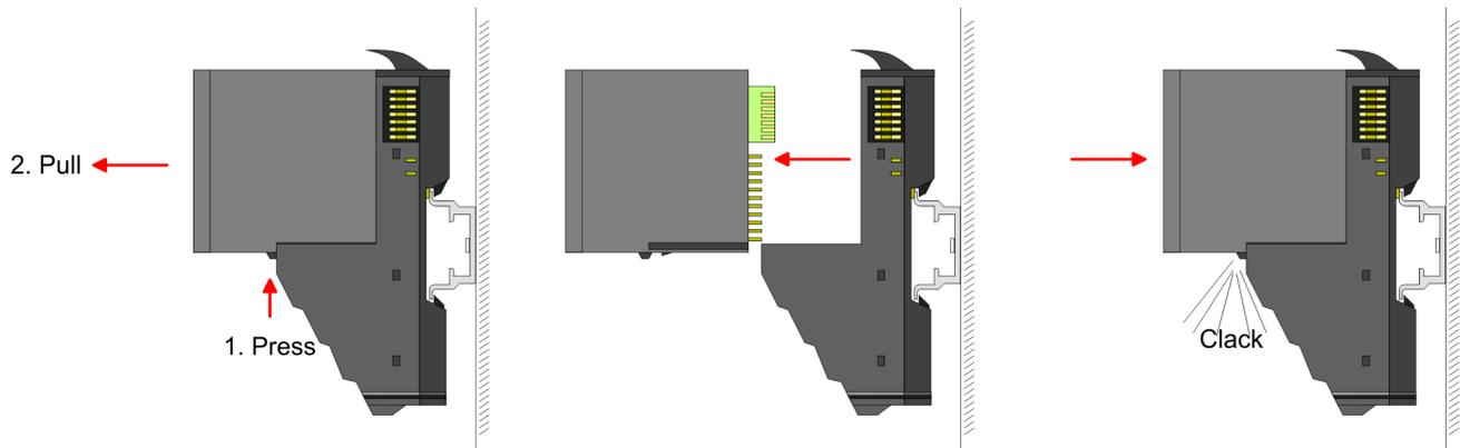
1. ➔ Zum Austausch eines Elektronik-Moduls können Sie das Elektronik-Modul, nach Betätigung der Entriegelung an der Unterseite, nach vorne abziehen.
