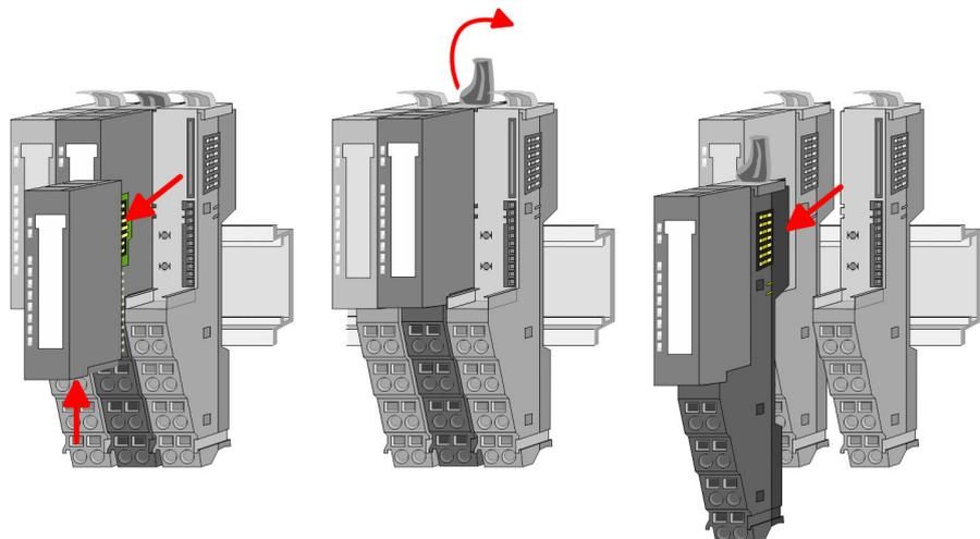
2. ➔ Betätigen Sie die Entriegelung an der Unterseite des rechts daneben befindlichen Elektronik-Moduls und ziehen Sie dieses nach vorne ab.
