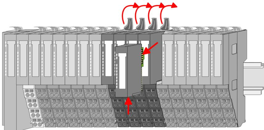
2. → Betätigen Sie die Entriegelung an der Unterseite des rechts neben der Modulgruppe befindlichen Elektronik-Moduls und ziehen Sie dieses nach vorne ab.
