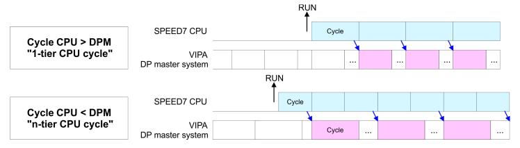
Setting VIPA specific CPU parameters > Yaskawa specific parameters
