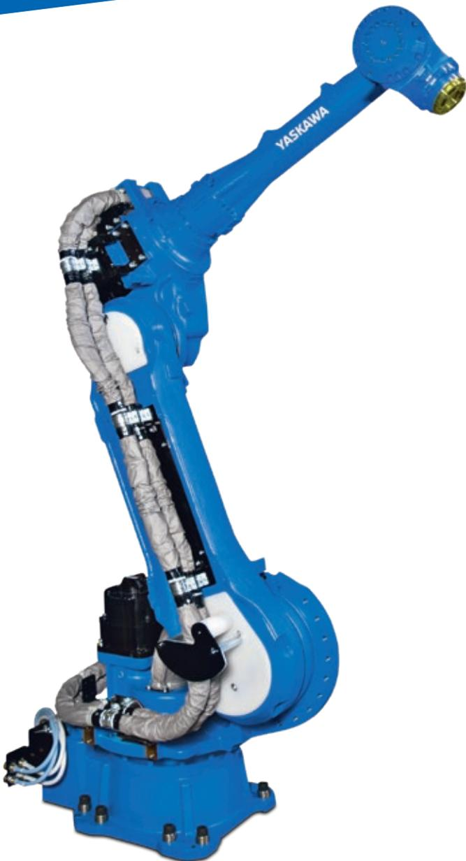
Der MOTOMAN SP80 ist ein kompakter Punktschweißroboter mit 80 kg Traglast für servogesteuerte Leichtbau-Schweißzangen. Mit dieser Technologie lassen sich sehr kompakte, taktzeitoptimierte, energieeffiziente und kostengünstige Schweißzellen auf kleinstem Raum installieren. Dieser Roboter eignet sich für kompakte Punktschweißlinien im Karosseriebau mit hoher Roboterichte, für das wirtschaftliche Schweißen kleiner Unterbaugruppen, sowie für den platzsparenden Aufbau auf einem Positionierer.
