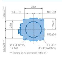
Montagemöglichkeiten: Boden IP-Schutzklasse: IP66/67
