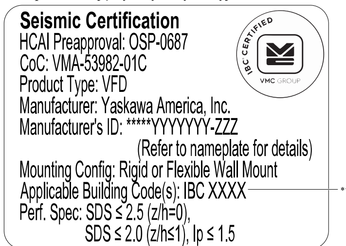
Rysunek 7.20 Przykład etykiety certyfikacji sejsmicznej dla falowników
